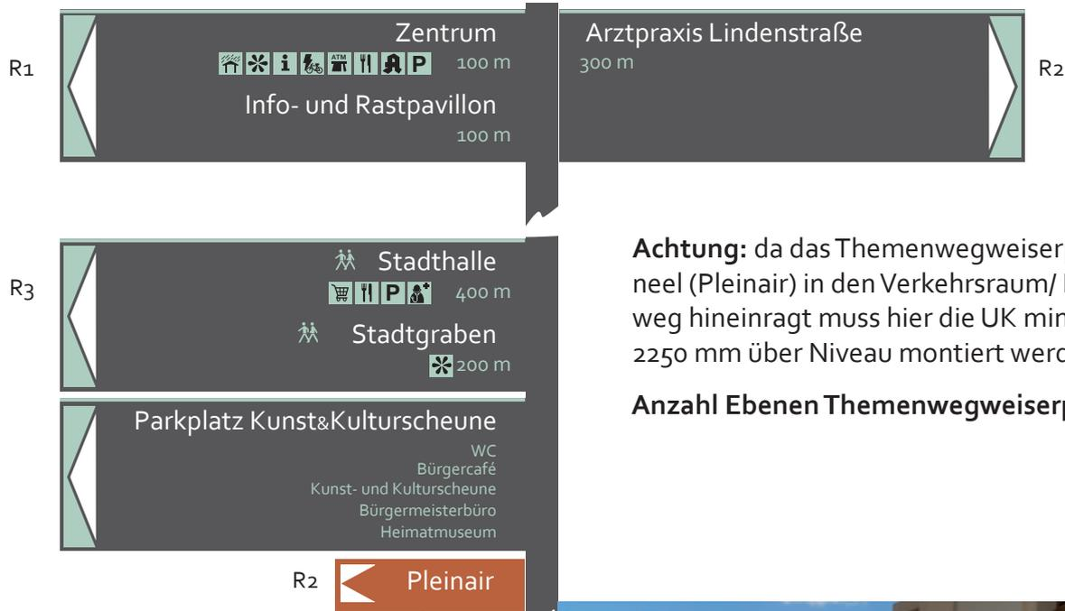
**Achtung:** da das Themenwegweiserpaneel (Pleinair) in den Verkehrsraum/ Fußweg hineinragt muss hier die UK mind. 2250 mm über Niveau montiert werden
