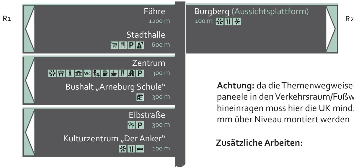
**Achtung:** da die Themenwegweiserpaneele in den Verkehrsraum/Fußweg hineinragen muss hier die UK mind. 2250 mm über Niveau montiert werden
