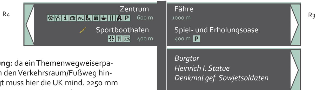
**Achtung:** da ein Themenwegweiserpaneel in den Verkehrsraum/Fußweg hineinragt muss hier die UK mind. 2250 mm über Niveau montiert werden
