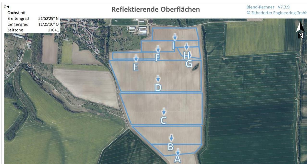
Abbildung 4 zeigt die Ausrichtung des PV-Feldes im Raum<sup>1</sup>. Die PV-Flächen wurden für die Berechnung als Vierecke modelliert. Sie sind auf dreireihigen Modultischen, hochkant, mit der Oberkante bei ca. 2,7 m angeordnet. Für die Streuung an den PV-Modulen wurde ein üblicher Streuwinkel von +/- 4° angenommen.
