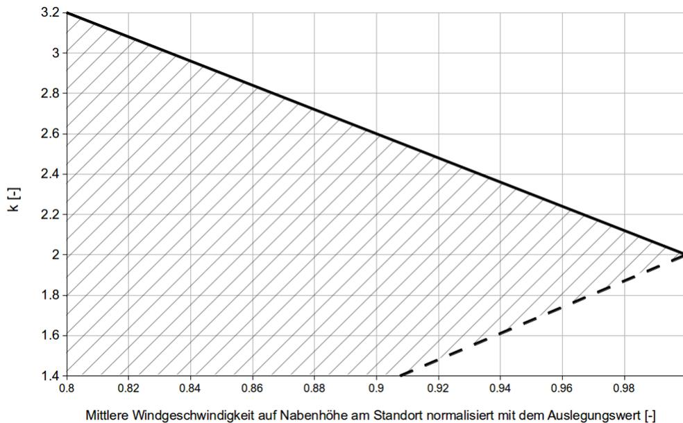
**Abbildung 2.1.1:** Mögliche Kombinationen von normierter Windgeschwindigkeit und Formparameter  $k$  der Weibull-Verteilung (schraffierter Bereich).
