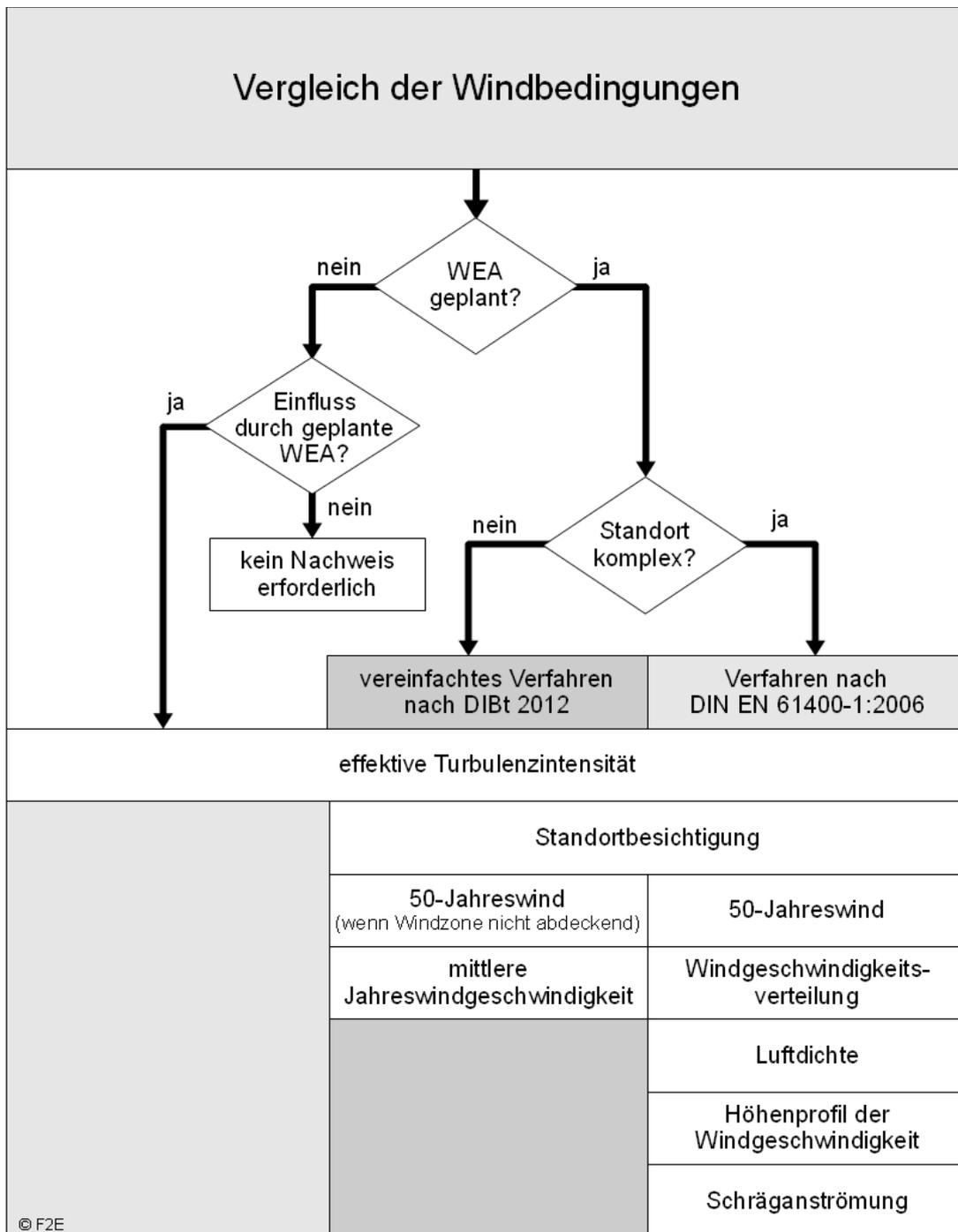
Abbildung 2.1.2: Nachweis durch Vergleich der Windbedingungen gemäß /2.8/.
