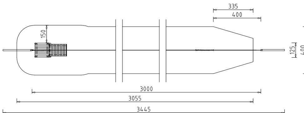
Beschreibung: 1 Bergstation, 1 Talstation, bestehend aus 2 Formrohr-Stützen aus Stahl, feuerverzinkt, Haltevorrichtungen und Spannvorrichtung für das Seilbahnseil, je eine Abspannung der Stützen in das Fundament. Stahlseil verzinkt  $\varnothing$  10 mm, 1 Laufkatze im Edelstahlgehäuse, mit Polyamidrollen, Seilführung und Bremse, 1 Pendelsitz an feuerverzinkter Kette, mit Schlauchüberzug, mit Anschlägen und Dämpfungsfedern bei Berg- und Talstation. 1 Startpodest, mit Startrampe
