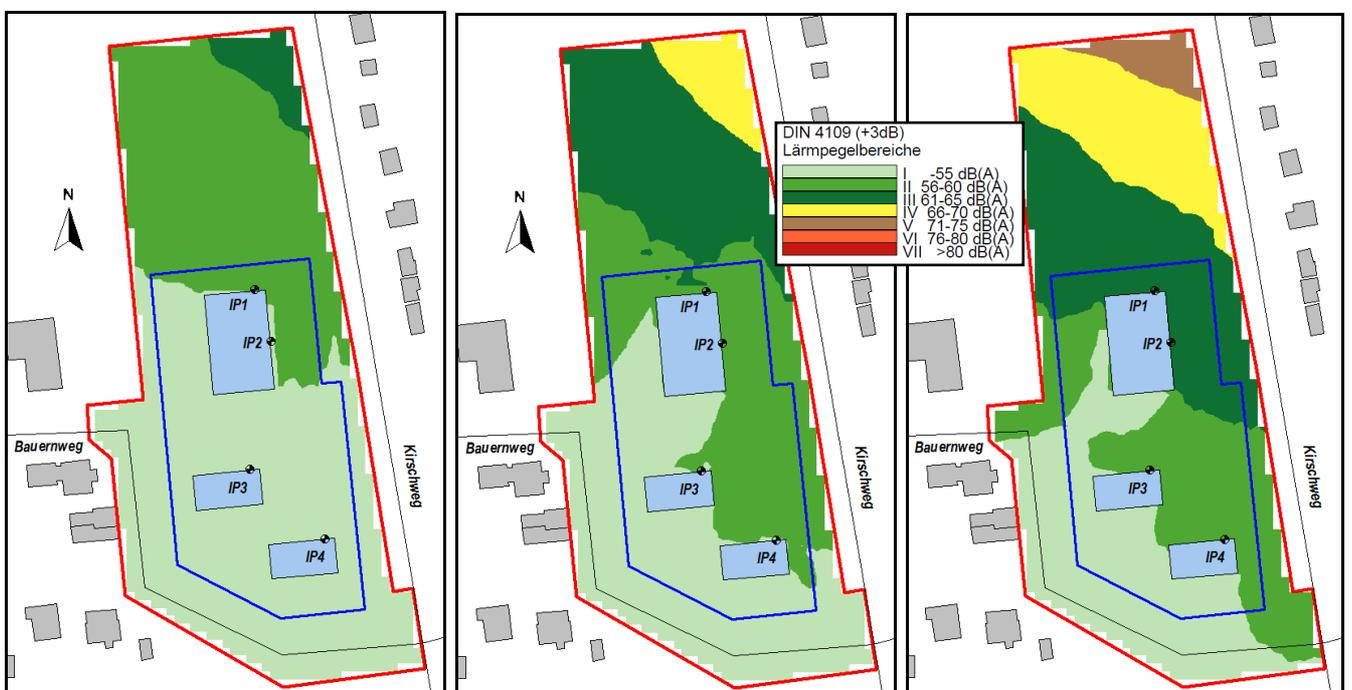
**Abbildung 4:** einwirkender Schienenverkehrslärm, Lärmpegelbereiche gemäß DIN 4109, Immissionshöhen: EG (links), 1.OG (Mitte) und 2.OG (rechts)
